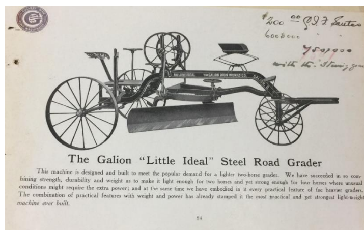
Figura 69- Modelos de carros e tratores importados, apresentados à Prefeitura municipal para auxiliar nas obras das estradas de rodagem. Na primeira imagem, um modelo de trator utilizado para pavimentação e o segundo, uma máquina mais leve, para ser puxada por dois animais. Fonte: Arquivo Histórico Municipal. Fundo Prefeitura Municipal de São Paulo, Diretoria de Obras e Viação, série Obras Públicas, caixa 154, 1917, processo nº 183576.
