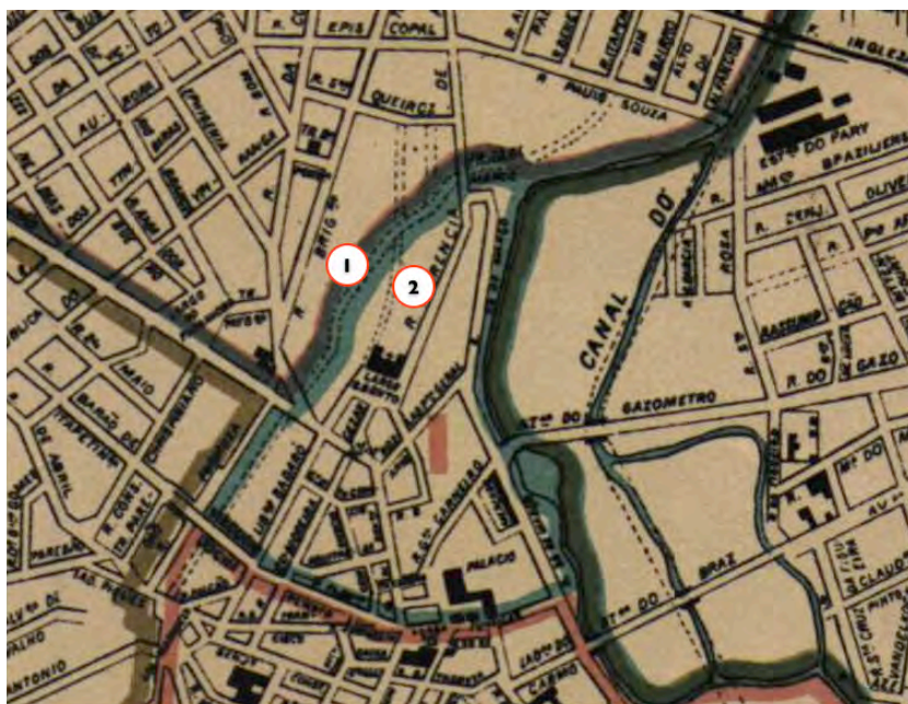
FIGURA 3.36 - Planta geral da capital de São Paulo organizada sob a direção do Dr. Gomes Cardim, 1897. Detalhe mostrando, em tracejado, provável projeto de canalização do ribeirão Anhangabaú, entre o Largo da Memória e sua foz, no rio Tamanduateí (1). Saindo do largo de São Bento, a “rua auxiliar à rua Florêncio de Abreu”, proposta por José Pereira Ferraz (2).
