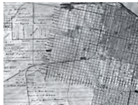
FIGURA 2.23 - Plano Ciudad del Rosario Ensanche y Puerto Aprobados, de los agrimensores Werner y Pusso, 1890. Detalhe. Observar que a estrutura fundiária e a quadricula não são coincidentes. (Fonte: ROSARIO (MUNICIPIO), 2007)
