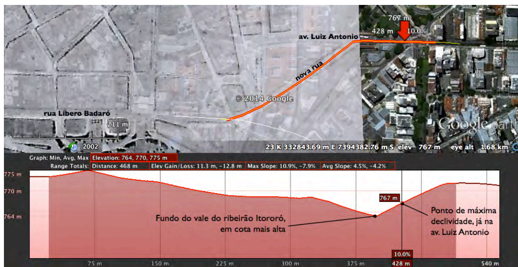
FIGURA 4.96 - Perfil longitudinal aproximado (com níveis atuais) da solução para a extensão da rua Libero Badaró prevista na Estampa 10 do Relatório de 1911... Na acomodação proposta, derivada do Plano Bouvard, o desnível não passaria de três metros. Desenhos acervo AHM sobre base GoogleEarth 2014.
