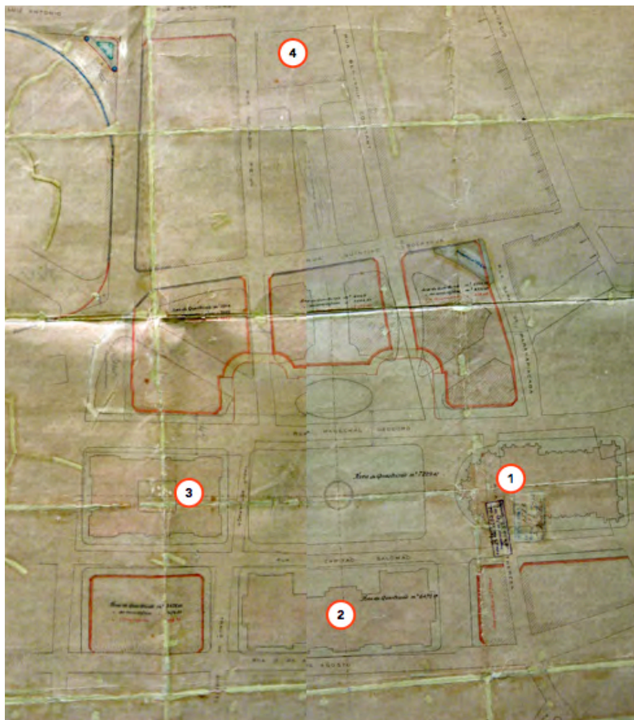
FIGURA 4.93 - À esquerda, a planta com a proposta da Diretoria de Obras Municipais para a alteração do Centro Cívico concebido por Bouvard. Em hachurado fino o projeto de Bouvard. Em vermelho, as alterações propostas. Tinta e grafite sobre papel. Acervo AHM. Foto da autora, 2011. À direita, detalhe da Estampa 10 do Relatório do Prefeito de 1911... assumindo as alterações.. Acervo AHM. Foto da autora, 2011.
