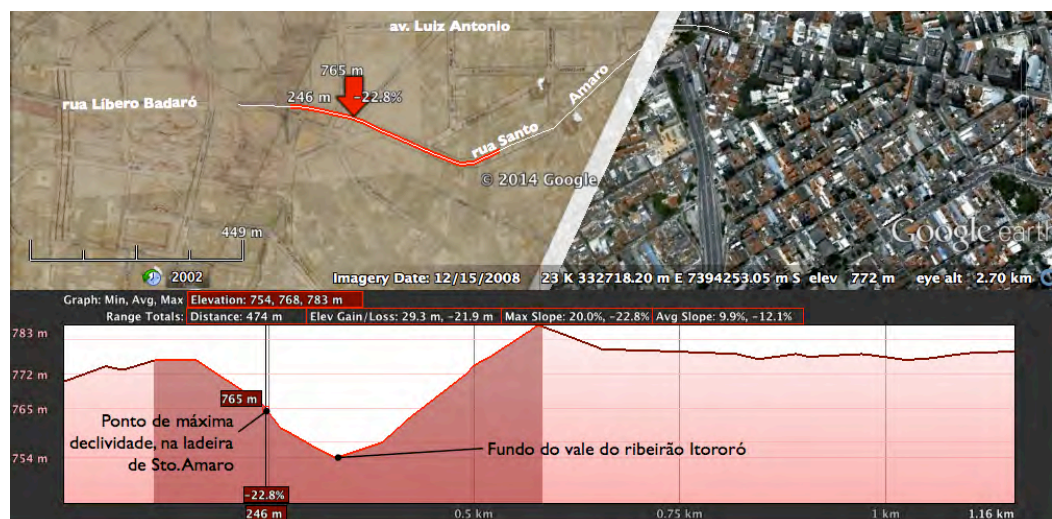
FIGURA 4.95 - Perfil longitudinal aproximado (com níveis atuais) da solução para a extensão da rua Libero Badaró prevista no Primeiro Plano da Diretoria de Obras Municipais ou Plano Freire-Guilhem. Na extensão pela rua Santo Amaro, a cota mais baixa chegaria a estar 17 metros abaixo do fim da rua Libero Badaró. Desenho Acervo Biblioteca FAUUSP sobre base GoogleEarth 2014.
