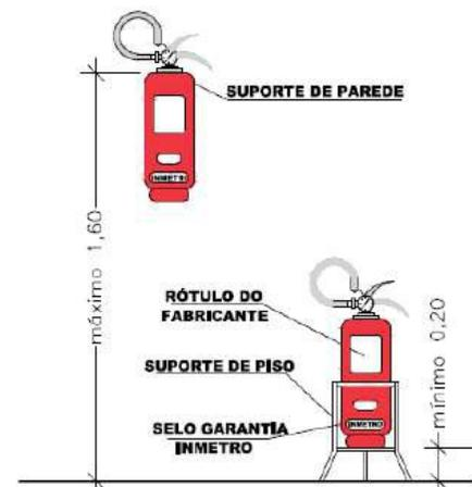
**DETALHE DE INSTALAÇÃO DE EXTINTORES SEM ESCALA**
